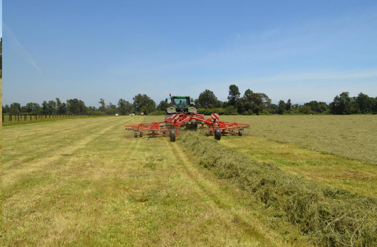
El paso del rastrillo produce hileras que permite la deshidratación del pasto a través del paso del aire y la cosecha del forraje
