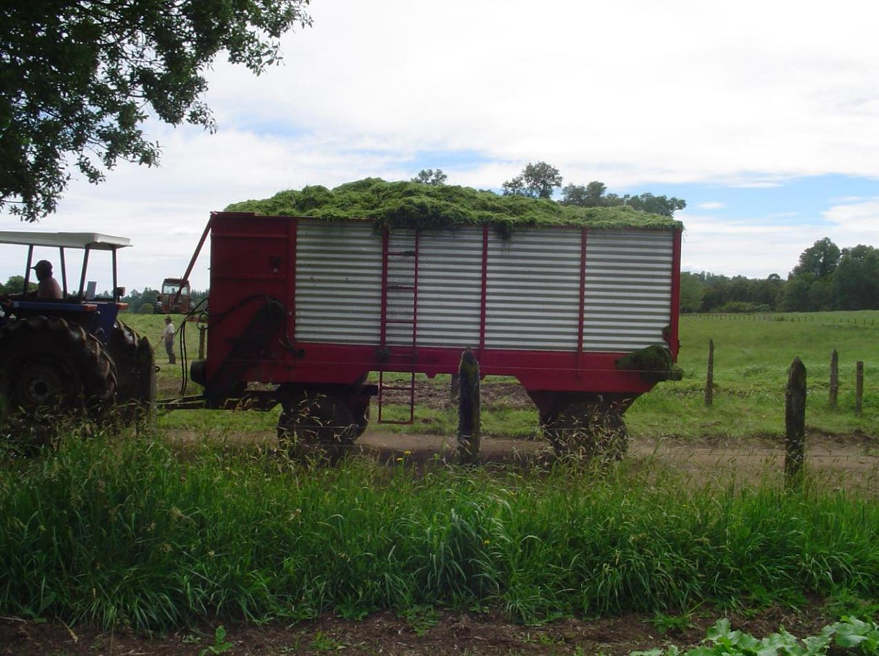
**El pasto es depositado en un carro de arrastre con barandas móviles o en tolvas de descarga que permiten una mayor velocidad de trabajo**
