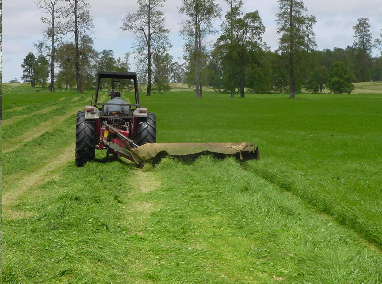
**El proceso se inicia con el corte del forraje con una máquina segadora con acondicionador**
