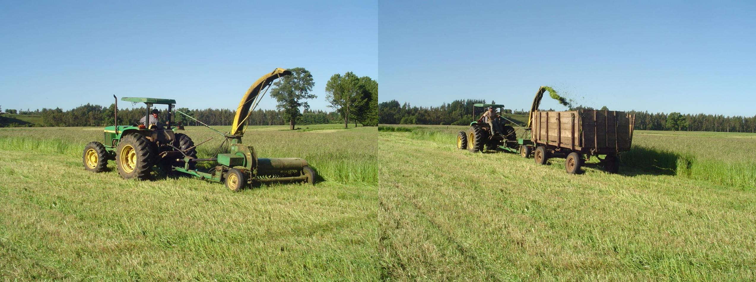
**Para regular el tamaño de picado del forraje la chopper posee la opción de utilizar tres o seis cuchillas en el repicador**
