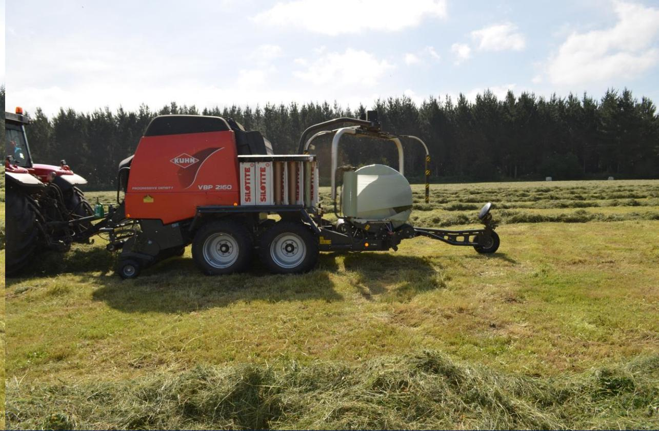
Los rollos de polietileno estirable se ubican en pilares laterales que giran y envuelven el bolo hasta dejarlo completamente sellado
