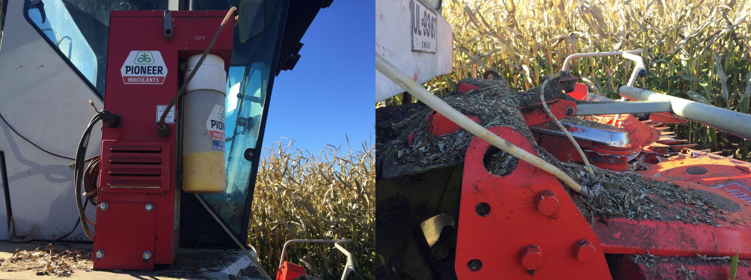
Los dosificadores de bajo volumen de agua se ubican al lado de la cabina del operador y la solución de agua con aditivo se asperja al forraje sobre el cabezal antes de que ingrese a la picadora de forraje
