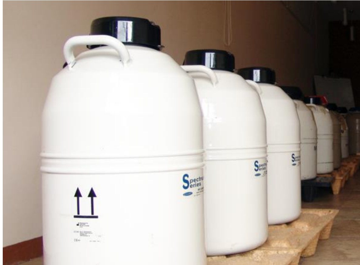
Termos con capacidad de 500 a 600 pajuelas y veinte litros de nitrógeno líquido
