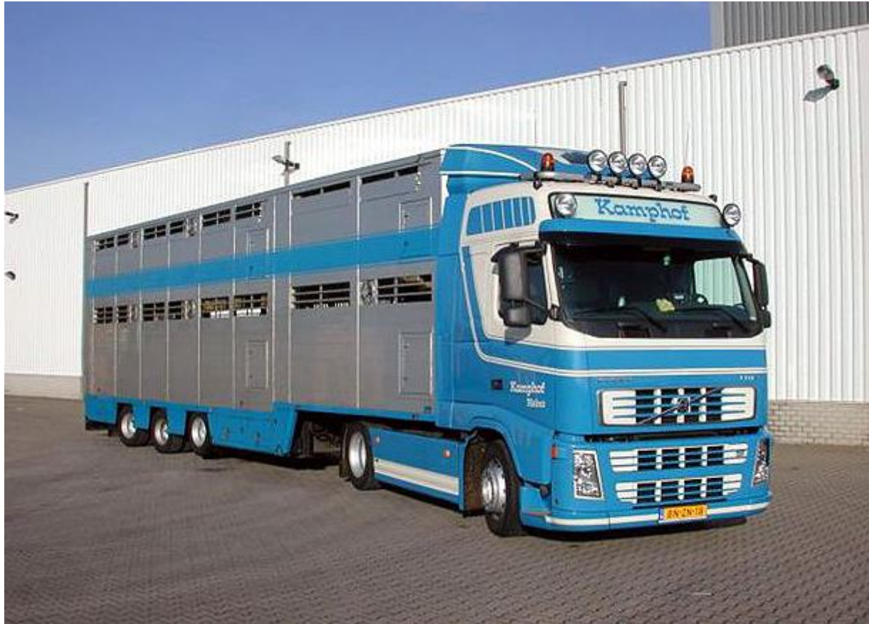
Camión Especializado en Transporte de ganado Capacidad 45 cabezas de bovinos tamaño > 500 kilos de Peso Vivo
