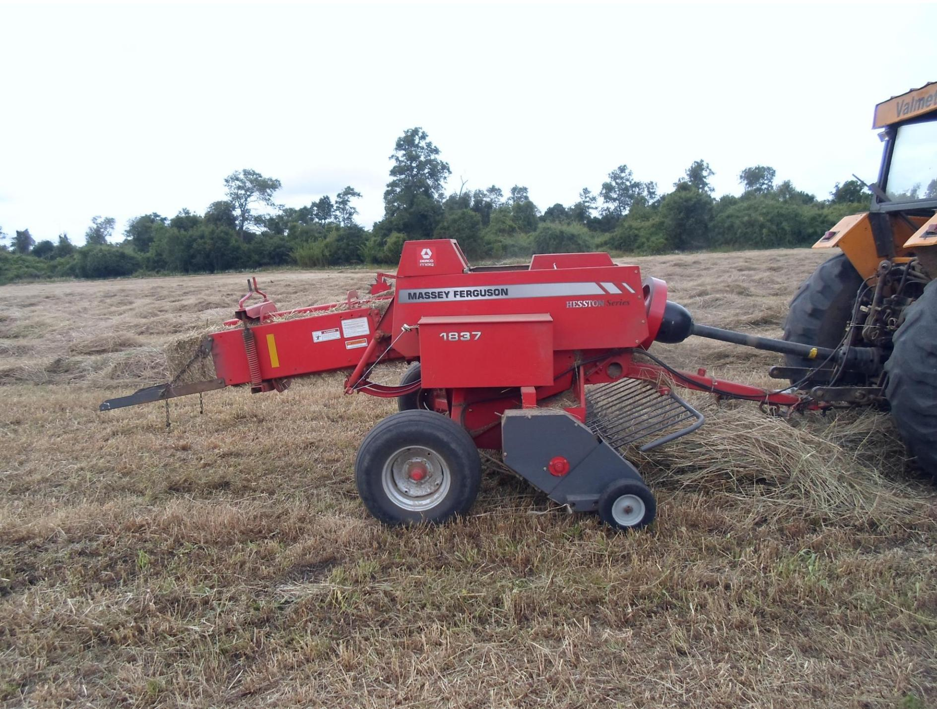
En el interior de la máquina el forraje es cortado a la forma del fardo y presionado para lograr una estructura sólida
