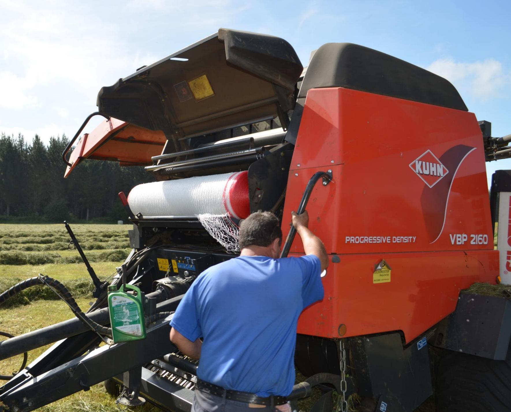
En el interior de la cámara se forma el bolo el cual es primariamente cubierto por una malla que mantiene la forma del bolo
