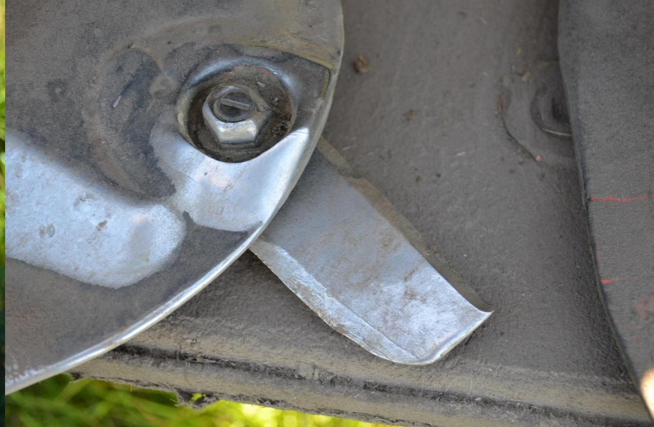
Desgaste de cuchilla cortadora de segadora de disco
