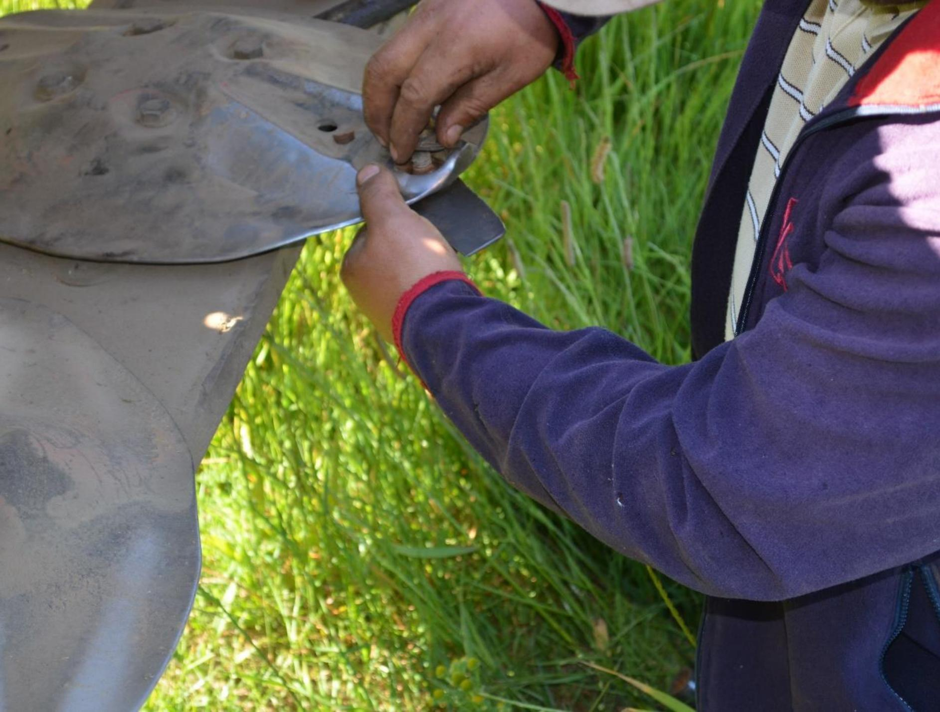
En la segadora de discos las cuchillas ubicadas en el eje horizontal rotan a una velocidad de entre 800 y 1.000 rev/min generando un corte del forraje por impacto
