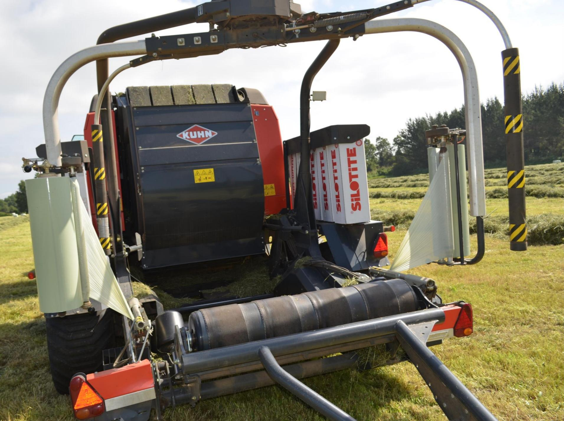
Los rollos de polietileno estirable se ubican en pilares laterales que giran y envuelven el bolo hasta dejarlo completamente sellado
