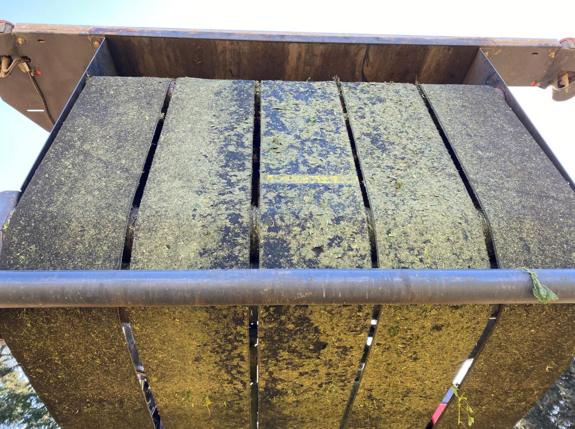
La falta de deshidratación se observa en las correas de la máquina emboladora
