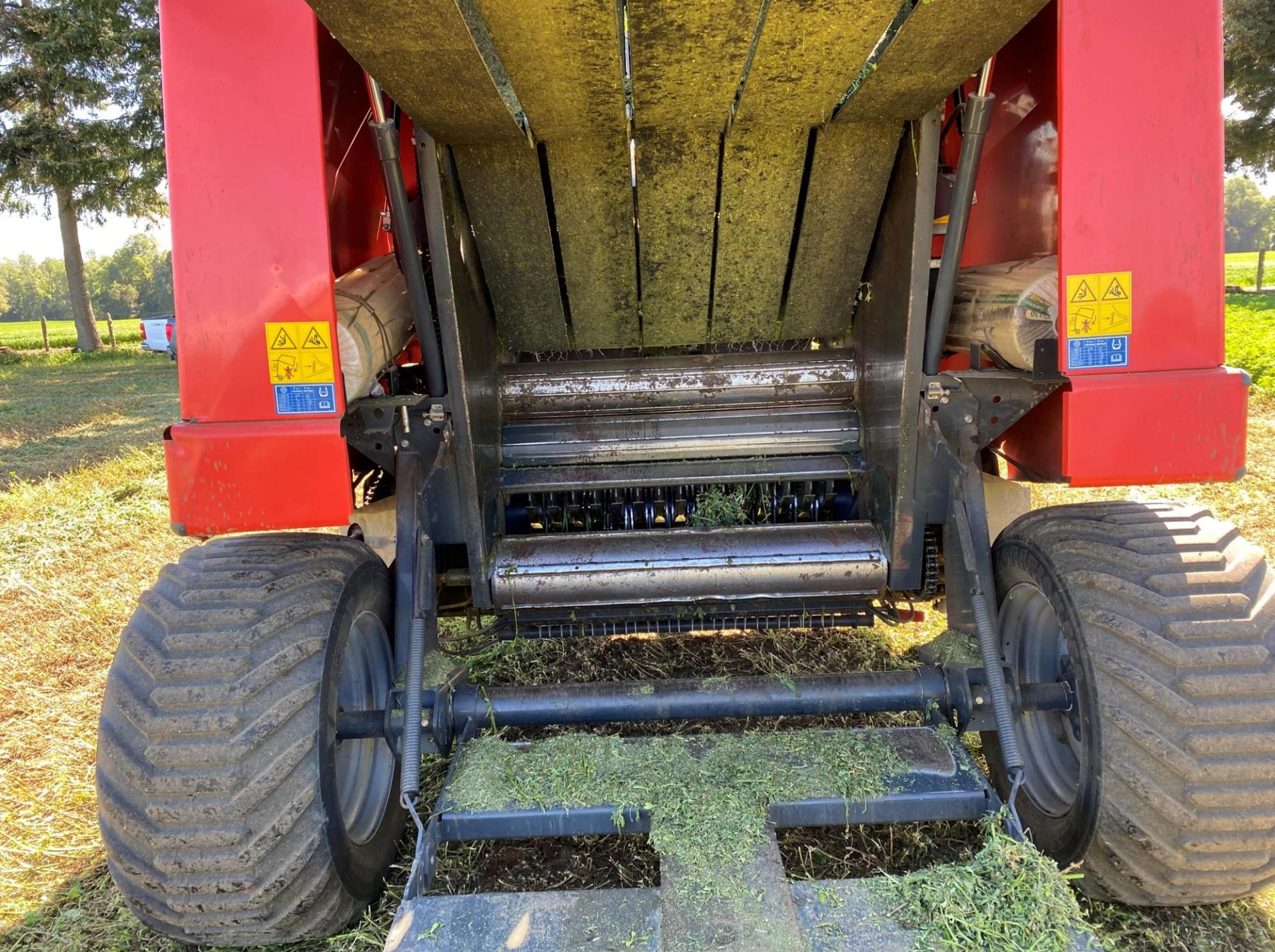
El exceso de humedad en el forraje que se está empacando es observado con facilidad en la máquina emboladora
