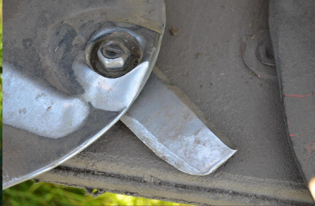
**Desgaste de cuchilla cortadora de segadora de disco**
