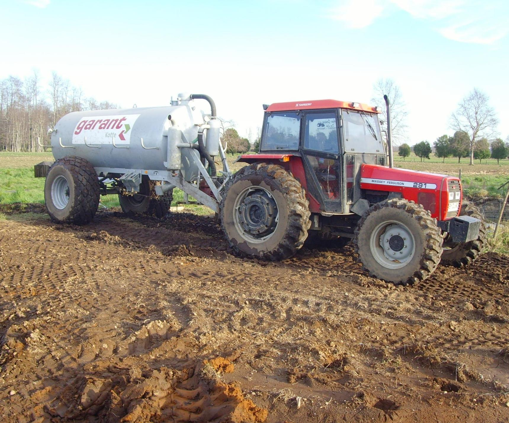
La aplicación convencional por aspersión con salida del purín a presión y choque sobre una platina genera un abanico con una gran superficie de contacto con el aire que favorece la **volatilización del amoníaco**
