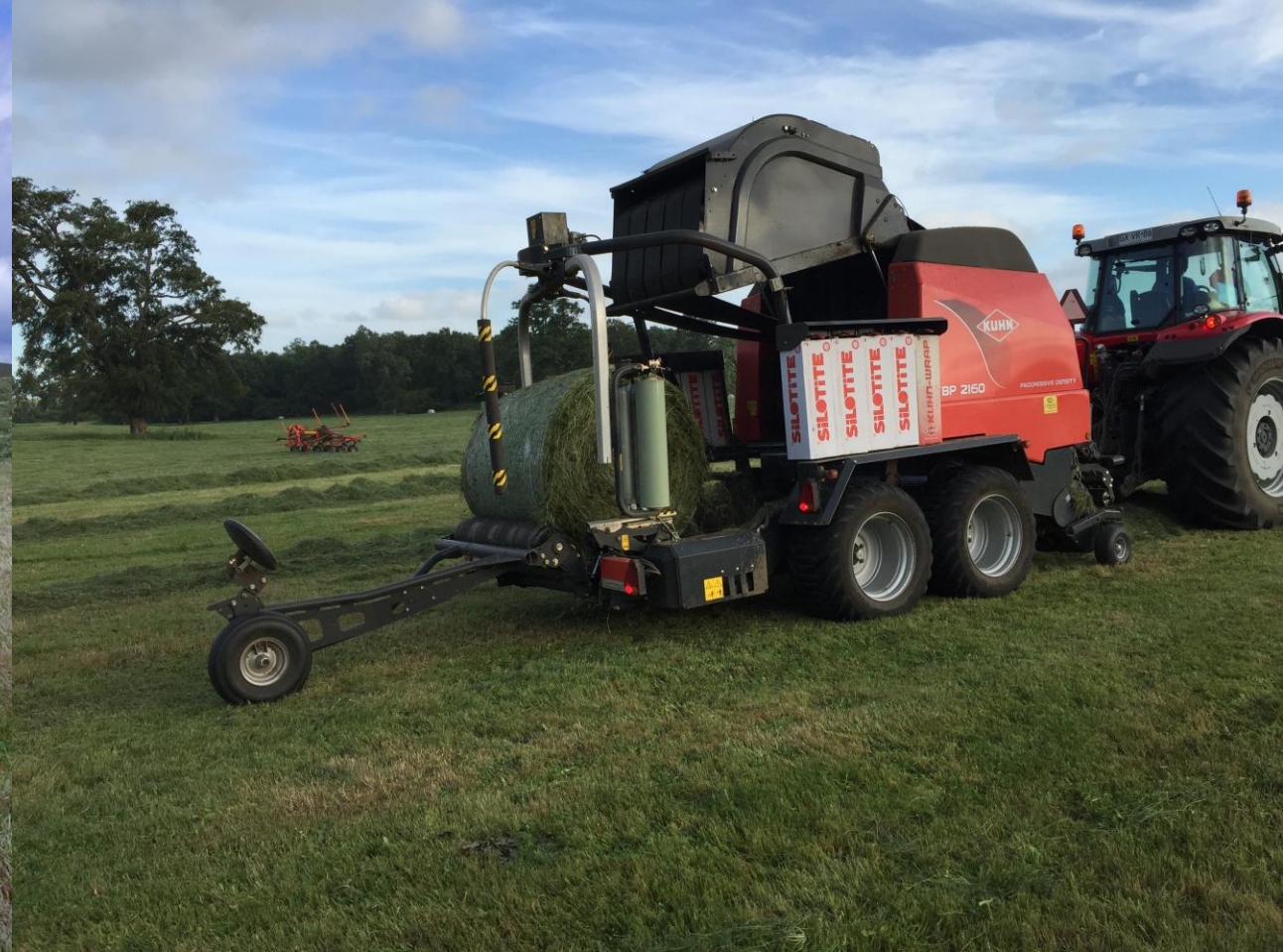
Máquina emboladora y selladora
