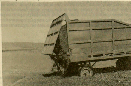
Un motor hidráulico acciona los mecanismos que permiten la descarga automática.
