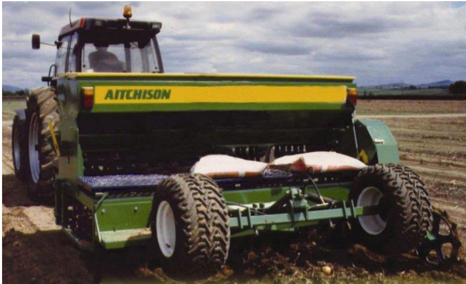
Sembradora en línea con alimentador de esponja y distancia entre hilera de 13,5 centímetros
