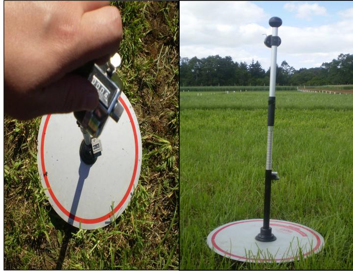
**Figura 3.** Plato Medidor de altura comprimida “Rising plate meter”.
