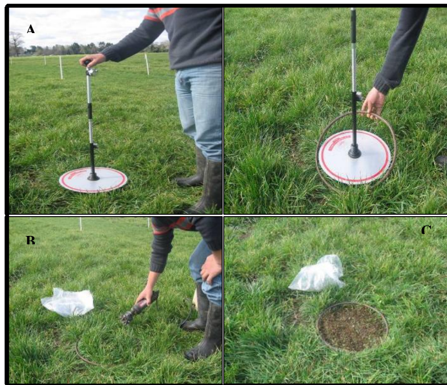
Figura 3. Proceso de calibración Medición del plato medidor de forraje. A; altura comprimida, B; corte de la fitomasa total bajo el área del plato; C; determinación de la cantidad de materia seca de la masa de forraje cortada.
