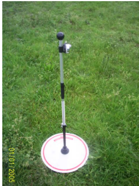
Figura 5. Plato medidor de pasturas o Rising plate meter.
