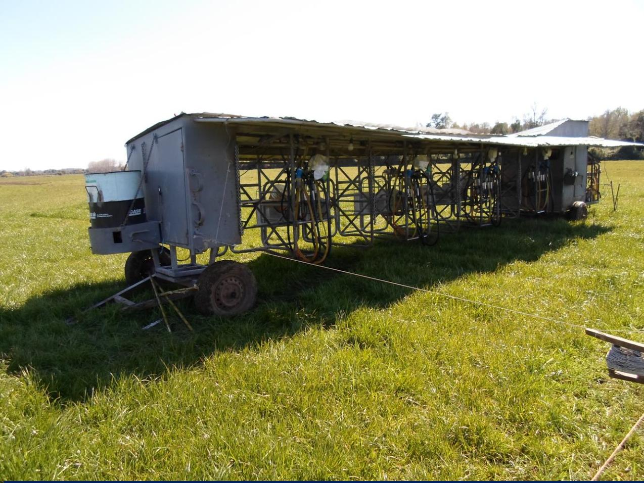
**Sala Portátil:** La sala es autónoma y posee un generador para la eléctrica y calefón para calentar el agua
